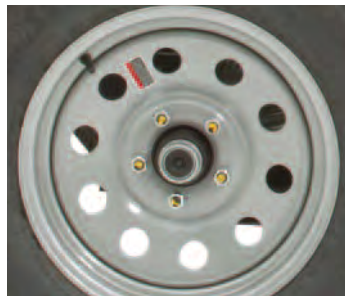
Engrasador de cojinete de rueda Ofrece una conveniente lubricación de los cojinetes de las ruedas a través de accesorios zerk.
